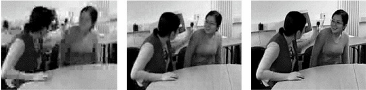
Abb. 9: Videoframe komprimiert mit derselben Bitrate in MPEG-2 (links), MPEG-4 Part 2 (mitte) und H.264 (rechts) [16].
